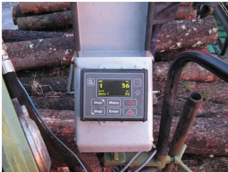
Mesure du poids chargé par chaque grappin à l'aide d'un peson
