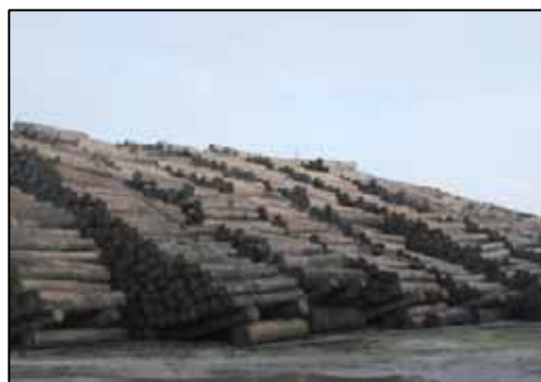
Plates-formes de stockage de bois de pin maritime sous aspersion en Aquitaine
