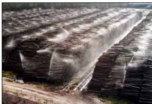
Plates-formes de stockage de bois de pin maritime sous aspersion en Aquitaine
