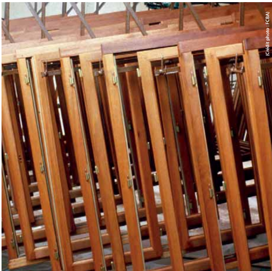
Les carrelages LCA sont de plus en plus utilisés pour fabriquer les châssis des menuiseries bois.
