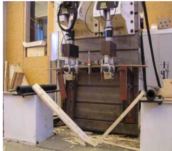
Fin de l'essai, destruction de la planche
