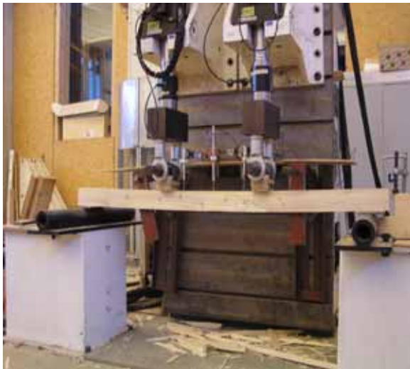
Début de l'essai de flexion 4 points
