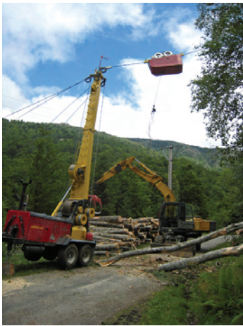
Le câble mât : un matériel de débardage moderne et technique, en plein essor dans l'arc alpin (Photo C. Périnot, FCBA)
