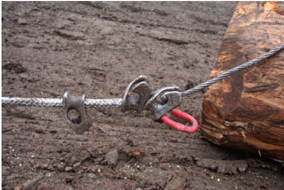
Le câble synthétique : un progrès en termes de sécurité et d'ergonomie pour les conducteurs de skidders (Photo P. Magaud, FCBA)
